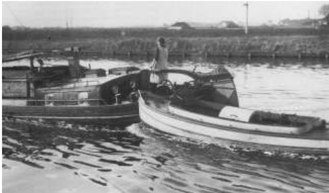
Afbeelding 17 : schip voortgestuwd door middel van een klein hulpvaartuig, de opduwer.
